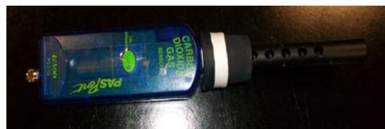
↑ 纏上止水帶的二氧化碳偵測器
