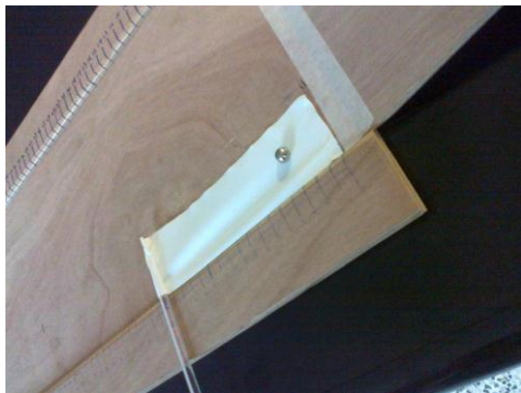
圖 11 將膠布一端距離約 1 公分處做上記號並且將溫度計黏貼於膠布上
