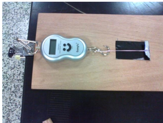
圖 18 另一端棉線則與電子彈簧秤繫緊
