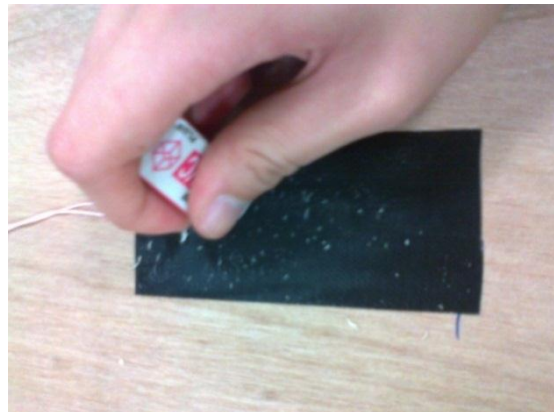
圖 16 取 4*10 公分膠帶，用橡皮擦來回壓實膠布，在 1 公分處標記
