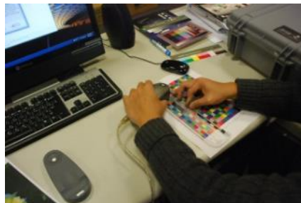
圖十、使用 Eye-One 色彩校正器掃描印出的圖形
