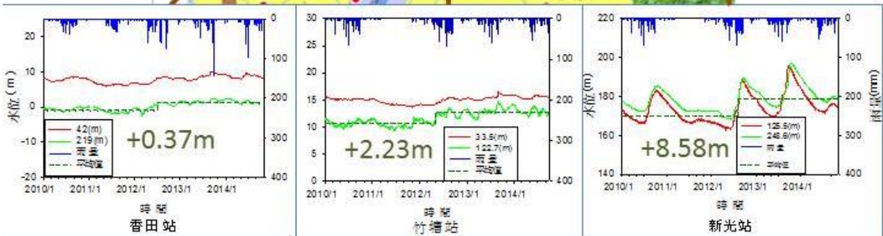
▲圖九 剖面一雨量與地下水位分析圖(2010~2014 年)
